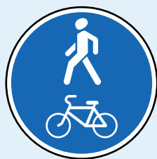
Пешеходная и велосипедная дорожка с совмещенным движением (велопешеходная дорожка с совмещенным движением)
